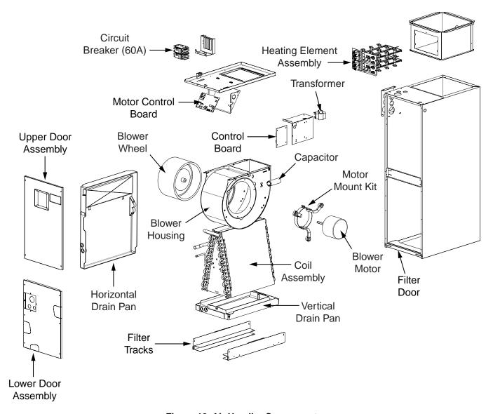
**Figure 12. Air Handler Components**
